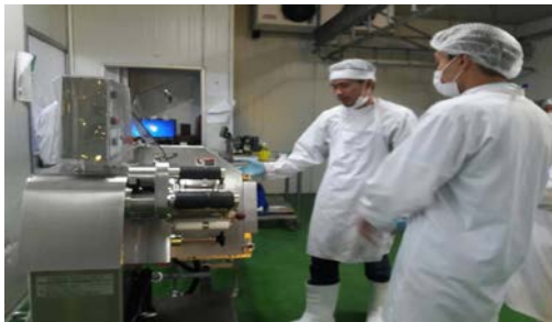
เครื่องแช่เนื้ออัตโนมัติ ขนาด 1,500 วัตต์ สหกรณ์โคเนื้อกำแพงแสน จำกัด จังหวัดนครปฐม
