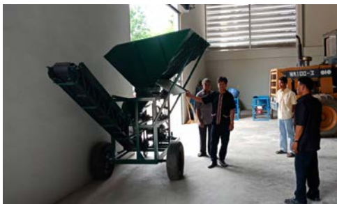
เครื่องสับมันสำปะหลัง สหกรณ์การเกษตรเขื่อนช้าง จำกัด จังหวัดศรีสะเกษ
